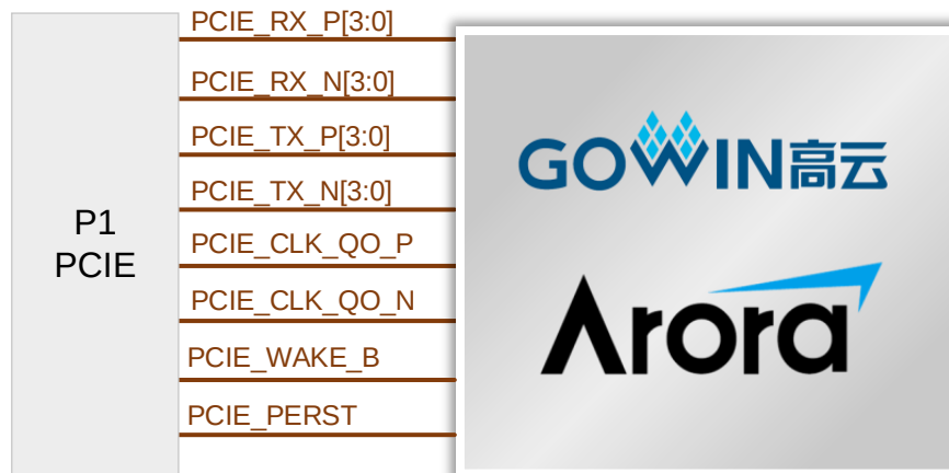
図 3-7 PCIe インターフェースの接続図
