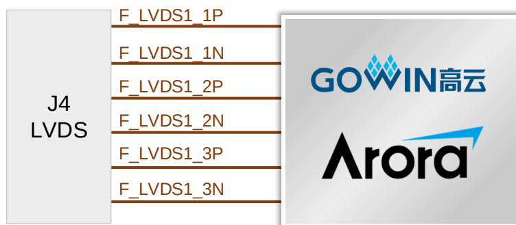
図 3-6 LVDS-RX インターフェースの接続図
