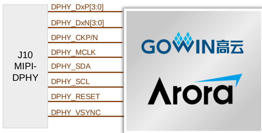
図 3-4 MIPI D-PHY インターフェースの接続図
