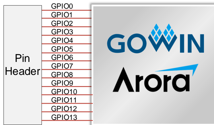
図 3-4 GPIO の接続図
