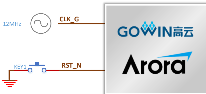
図 3-2 クロックとリセットの接続図
